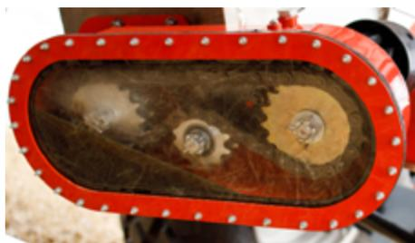
As carretas de 1 eixo modelo 20.000, 42.000 de esteira e as 2 eixos modelos 20.000, 25.000, 30.000 e 35.000 contam com transmissão por sistema de engrenagem com corrente banhada a óleo, eliminando a caixa de transmissão e permitindo a fácil manutenção.
