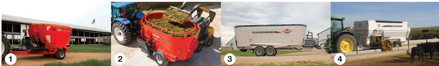
1. Misturadores de ração total verticais com uma rosca / 2. Misturadores de ração total verticais com 2 roscas / 3. Misturadores de ração total verticais com 3 roscas / 4. Misturadores de ração total horizontais com 4 roscas
